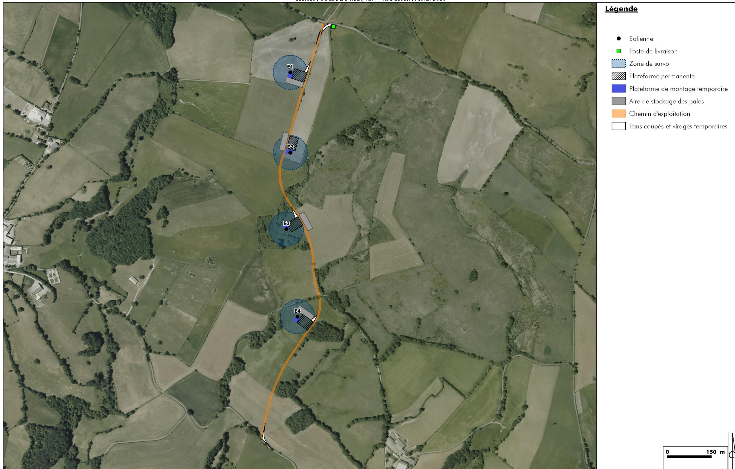
Illustration 2 : Plan masse du parc éolien Sources : SOLEIL DU MIDI, IGN / Réalisation : Artifex 2020
